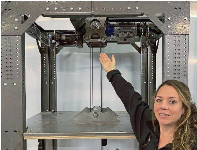
Erklärung des Kegelstirnrad-Getriebebremsmotor mit Ausgleichswaage links und doppelter Bremse rechts
